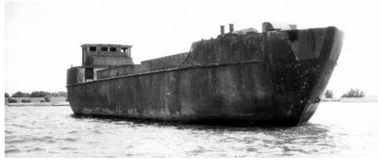
Betonschiff vor Redentin, 1984
